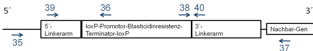
Abbildung 4.33: Schema des integrierten knockout -Konstruktes in die genomische DNA, die Primeranlagerungsstellen sind mit Pfeilen gekennzeichnet
