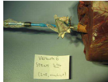
Abb. 49: S9B, fehlerhafter Release bei Steckenbleiben zweier Zacken im Schieber
