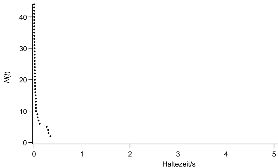
Abb. 61. Azobenzol/PEG-Silan in Wasser bei 750 pN Haltekraft und einer Temperatur von 40.0 °C. Federkonstante: 7.06 pN/nm (Veeco MLCT); Integral Gain = 3.
