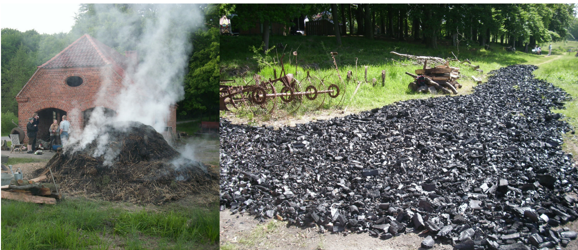
Abb. 16: Versuchsmeiler Molfsee 5 im Betrieb, daneben die gewonnene Holzkohlemenge.
