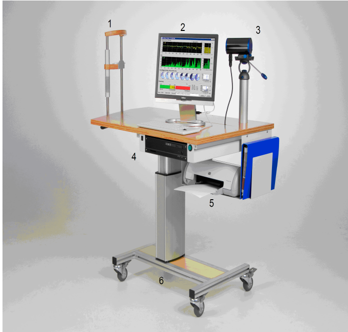
Abb. 3: PST-Messplatz (Abbildung mit freundlicher Genehmigung der Fa. AMTech) 1 Kopfstütze 2 Monitor 3 Videokamera 4 Rechner 5 Drucker 6 mobiler Tisch
