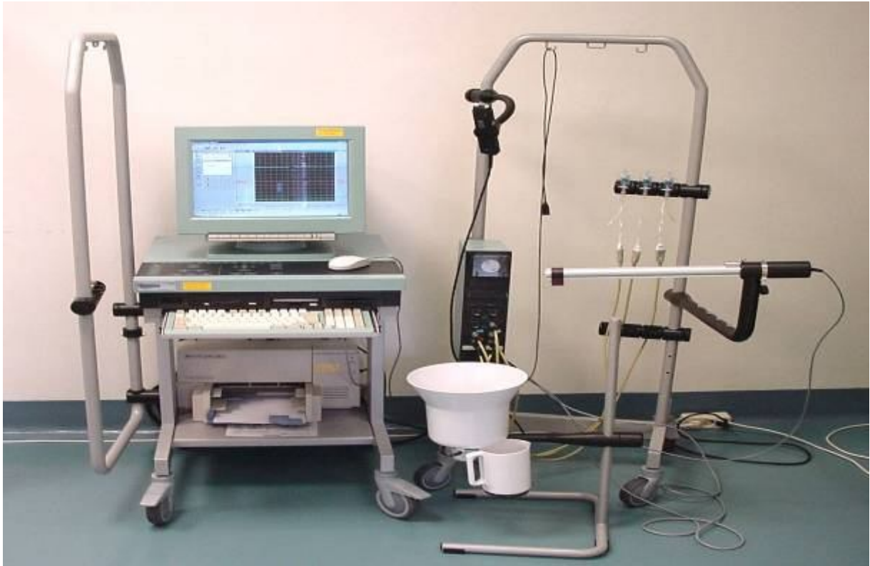
Abb. 2 Urodynamischer Messplatz einer computergestützten Mess- und Auswertungssoftware. Dieser Messplatz erlaubt die online Registrierung der mit dem Perfusions-Messkatheter registrierten Druckwerte und kann zusätzlich die Daten für eine nachträgliche Bearbeitung zur Verfügung stellen.
