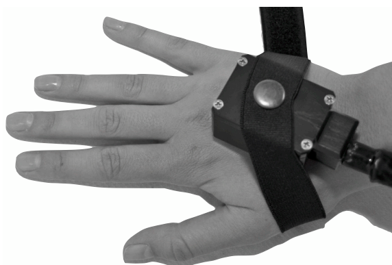
Abbildung 4: Thermode auf der Hand einer Probandin
