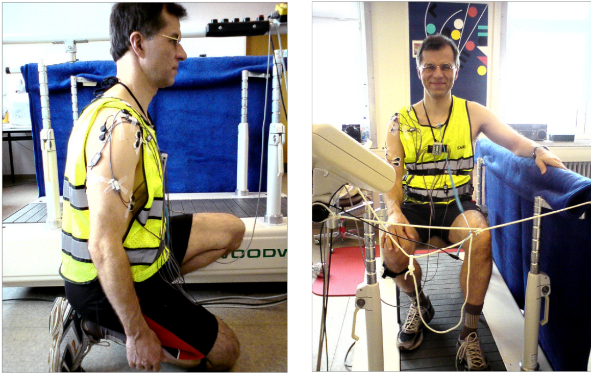
Abb. 1: Proband mit verkabelten EMG-Elektroden, die über Schulter- und Armmuskeln der rechten Seite befestigt sind.
