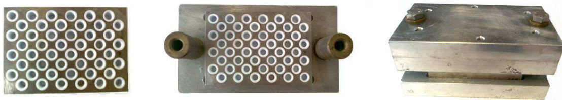
Abbildung 3.2 Hochdurchsatzautoklav zur solvothermalen Synthese von anorganisch-organischen Hybridverbindungen. Links: Stahleinsatz mit 48 einzelnen Teflonreaktoren. Mitte: Stahleinsatz im unteren Bauteil des Autoklaven. Rechts: Verschraubter Hochdurchsatzautoklav.
