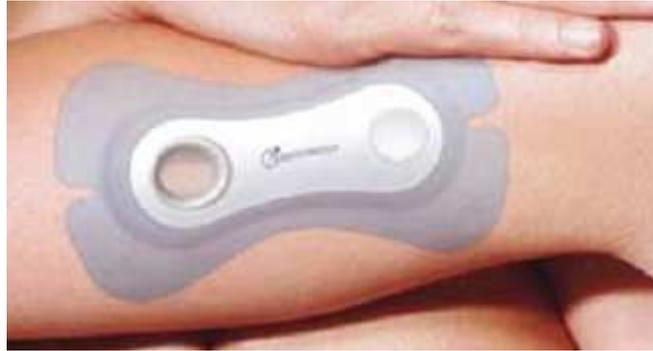
**Abbildung 51:** Prototyp eines Akzelerometers in Pflasterform der Firma BodyMedia.
