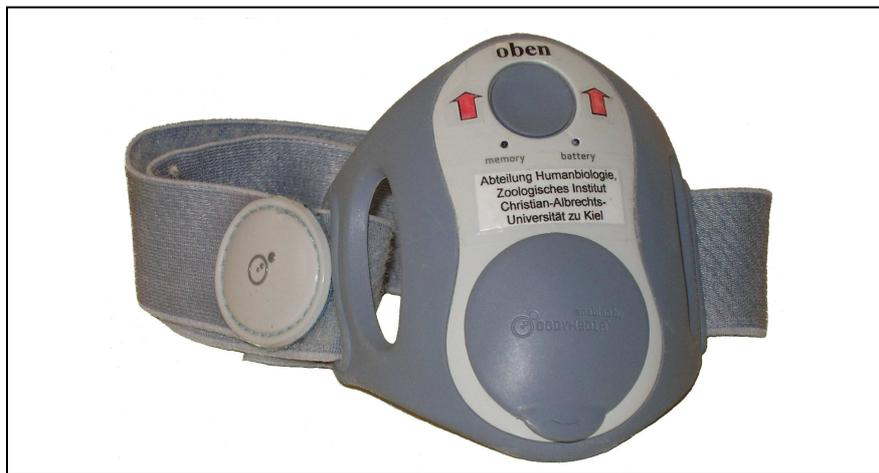
**Abbildung 17:** SenseWear Pro2-Akzelerometer der Firma SMT medical technology GmbH & Co., Würzburg. Das Gerät ermöglicht mit Angabe demographischer Werte (Alter, Geschlecht, Körperhöhe und Gewicht) die Berechnung von gesamtem und aktivem Energieumsatz, Liegedauer, Schlafdauer und Dauer körperlicher Aktivität. Zudem ist ein Schrittzähler enthalten. Foto: Autorin
