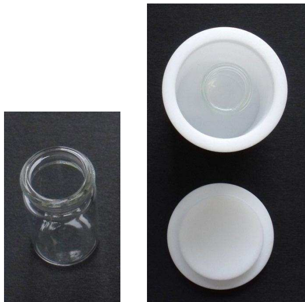
Abb. 3.3 Zur Synthese über die Dampfphase wird der Wirt in ein Rollrandglas eingewogen (links), welches anschließend in einem Tefloneinsatz platziert wird. Um das Rollrandglas wird der Farbstoff im Tefloneinsatz verteilt (rechts).
