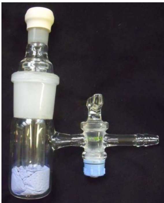
Abb. 3.5 Modifizierte Schleckapparatur zur Aktivierung und Umsetzung der \text{NH}_2 -modifizierten MOFs.
