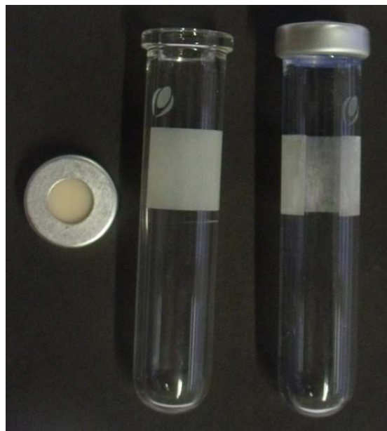
Abb. 3.4 Zur post-synthetischen Modifizierung \text{NH}_2 -funktionalisierter MOFs wurden 2-5 mL Mikrowellenröhrchen der Firma Biotage verwendet.
