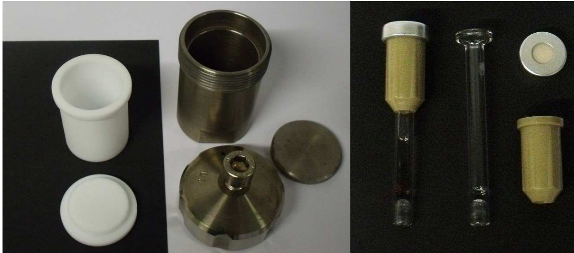
Abb. 3.1 Solvothermalsynthesen können in unterschiedlichen Gefäßen durchgeführt werden: z.B. im Stahlautoklaven (Mitte) mit Tefloneinsatz (links) oder in verschlossenen Gefäßen wie z. B. die hier dargestellten Glasgefäße (rechts).
