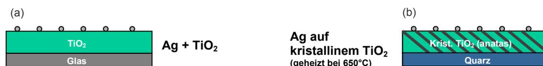
Abbildung 4.2 Schematische Darstellung der untersuchten 2D-Komposite.
