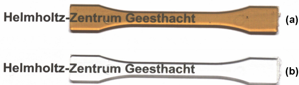
Abbildung 7.5: (a, b) SAN (Luran ® 358N) als Prüfkörpertyp 1BA: (a) mit 2% Silica-Nanopartikeln SAN-modifiziert („klassischer“ ATRP) und Partikelbehandlung mit HCl-Ethanol (Kapitel 4.3.5), (b) ohne Füllstoff.
