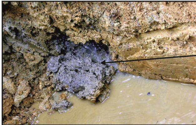
Wasseraustritt aus beschädigtem Sarg und reduzierter Boden
