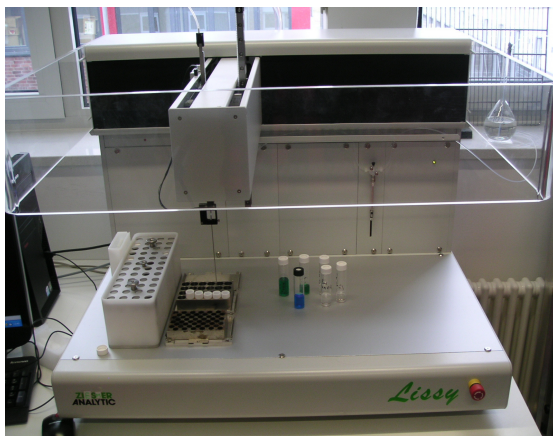
Abbildung 3.1: Links der im AK Stock verwendete Pipettierroboter, rechts ein 24er-Multiklav mit eingesetzten Teflonreaktoren.
