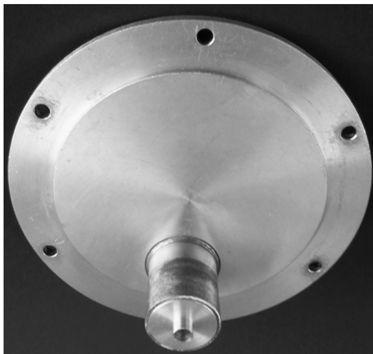
Abbildung 3.14: Modifikation der Düse für eine verbesserte Abscheidung
