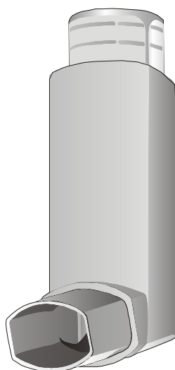
Abbildung 4.4: Schematische Abbildung der Mundstückgeometrie aller untersuchten BDP 250 µg Präparate
