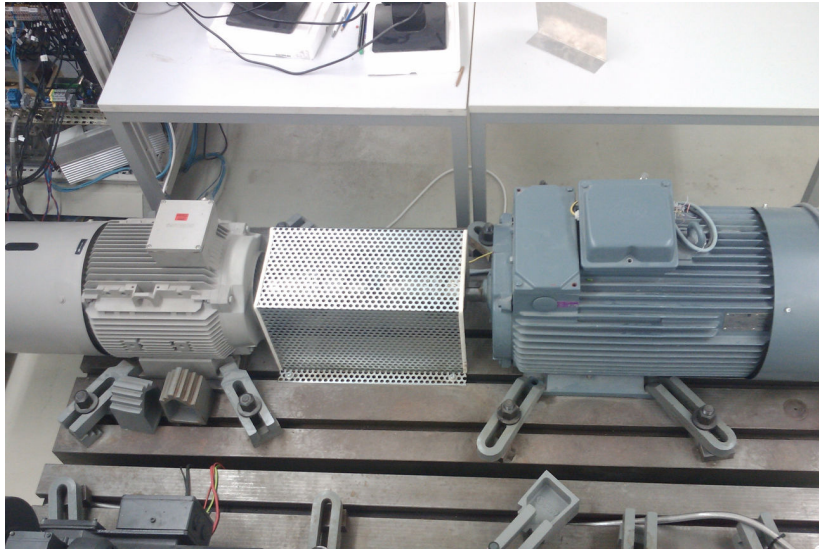
Abbildung 10.6: Laboraufbau der doppeltgespeisten Asynchronmaschine mit Antriebsmaschine
