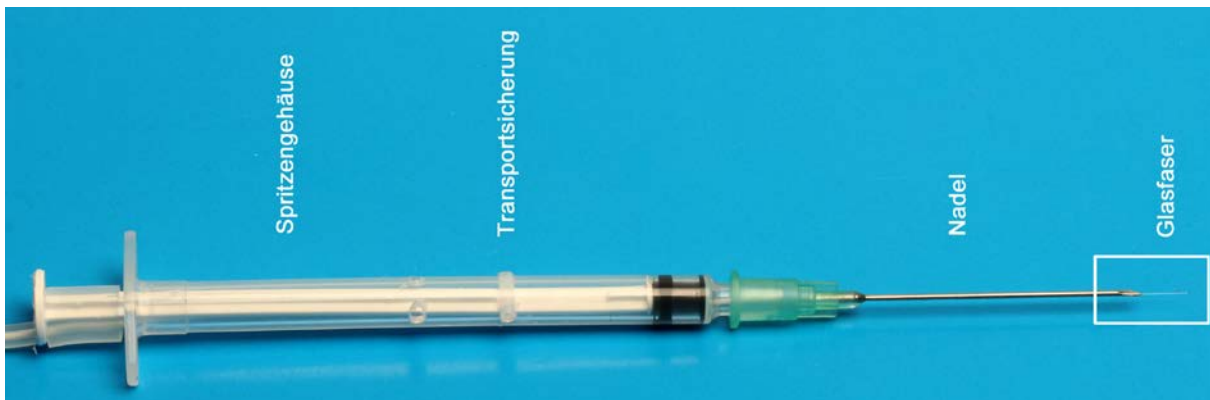
Abbildung 5: Zeigt die Meßsonde mit ausgefahrener Glaserfaserspitze. Das weiße Quadrat markiert den Ausschnitt, der in Abbildung 6 zu sehen ist.
