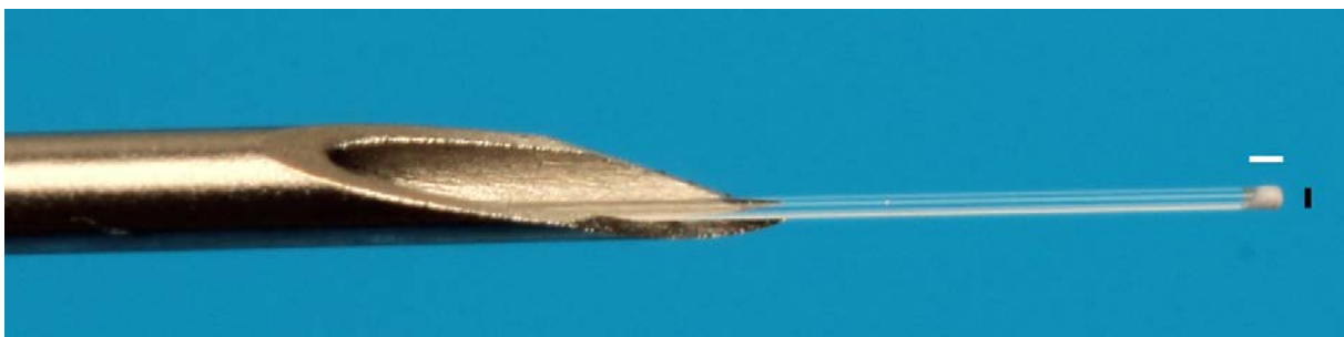
Abbildung 6: Zeigt die ausgefahrene Glasfaser sonde mit dem aufgebracht Farbstoff. Der Farbstoff wurde auf eine Länge von 280 µm (weiße Balken), bei einem Durchmesser von 140 µm (schwarzer Balken) aufgebracht.
