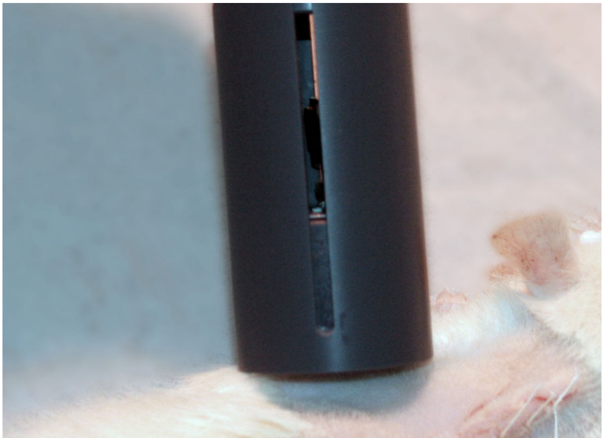
Abbildung 9: Zeigt eine durchgeführte Wirbelstrommessung. Hierbei wurde die Ratte in Bauchlage gelegt und der Wirbelstromsensor im 90° Winkel, unter Hautkontakt auf das Scaffold gehalten. Nach jeder durchgeführten Messung wurde der Sensor angehoben und erneut platziert.
