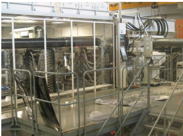
Abb. 4: Spritzgießmaschine für Autodächer, BMS; Quelle: Baylab plastics von Bayer MaterialScience in Leverkusen
