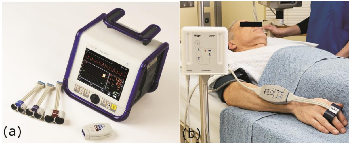
Abbildung 3 (a) zeigt den CNAP™ Monitor, seinen Cuff-Controller und die drei Fingermanschetten in den verschiedenen Größen (Quelle: CNSystems Medizintechnik AG, Graz, Österreich) und (b) die Anwendung des Geräts am Patienten
