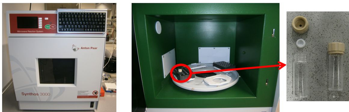
Abbildung 2.6.: Der Mikrowellen Reaktor Synthos 3000 der Firma Anton Paar (links), der Rotor (mitte) und die verwendeten Mikrowellenreaktoren (rechts).
