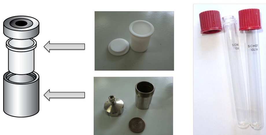
Abbildung 2.1.: Schematische Darstellung eines Stahlautoklaven mit Tefloneinsätzen ( links ), die im Arbeitskreis verwendeten Reaktoren ( mitte ) und die verwendeten Glasreaktoren ( rechts ).
