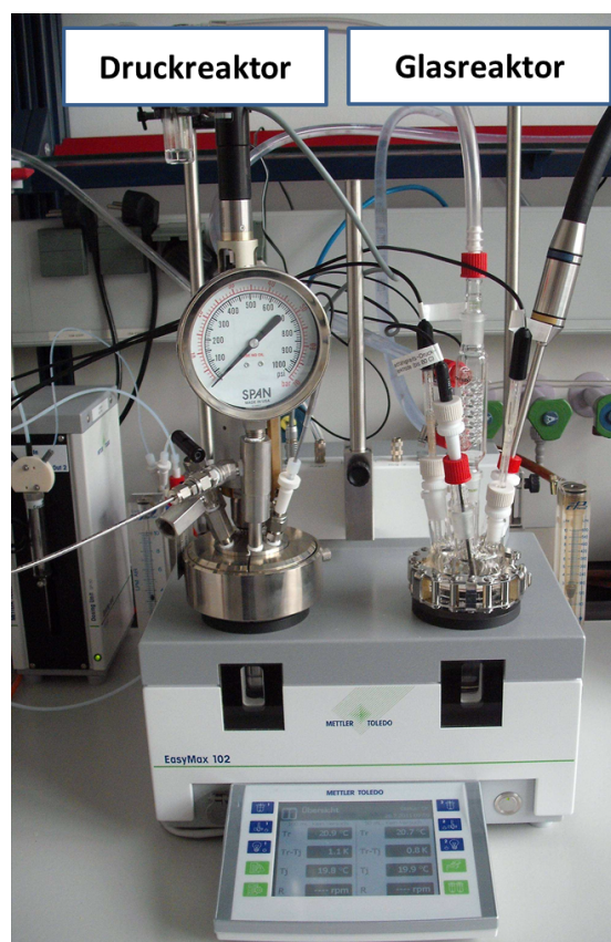
Abbildung 4.19.: In situ Kristallisationszelle. Links der Druckreaktor und rechts der Glasreaktor für Niedrigtemperatursynthesen.
