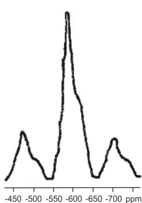
Abb. 51: ^{51}\text{V} -Festkörper-NMR der in HEPES- und HES-Pufferlösung vorliegenden Festphase (9,4 T; 12,0 kHz).
