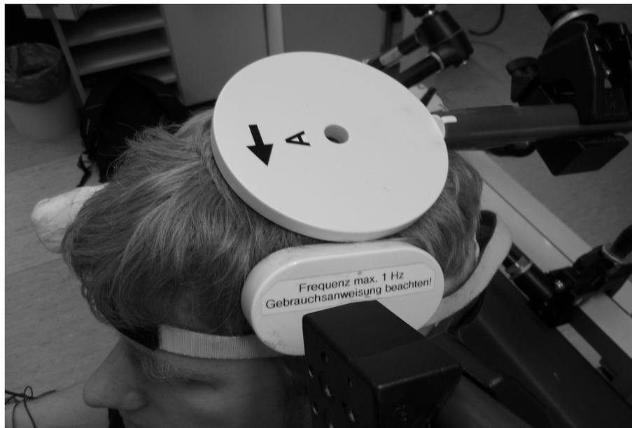
**Abb. 6:** *Experiment 1.2: Stimulation vom iM1 mit der runden Spule und iPMv mit der kleinen Spule.*
