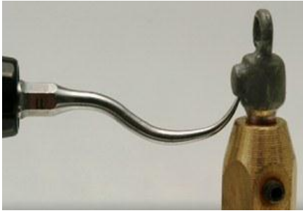
Abb. 2.15 Ultraschallbelastung des Probekörpers
