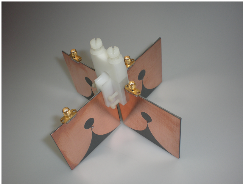
Abbildung A.2: Dual polarisierte Antenne bestehend aus vier Vivaldi-Antennen in überkreuzter Anordnung.
