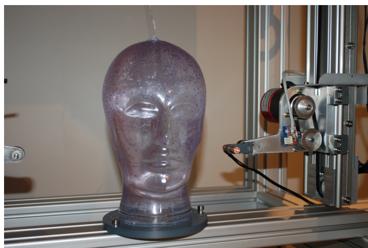
Abbildung 5.9.: Kopfphantom mit homogener Leitfähigkeit und eingesetzter Hirnschrittmacherelektrode
