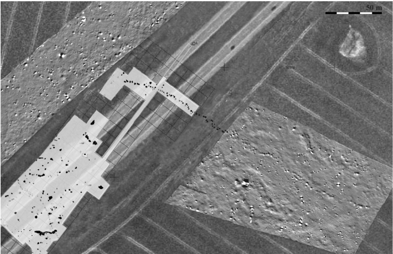
Abb. 9. Ausschnitt von Abb. 8 und 10 (ohne Höhenlinien): SQUID-Magnetogramme mit sichtbarer Fortsetzung der Grubenreihe im Südost-Magnetogramm (zwischen Grabungsplan und SQUID-Magnetogramm im theoretischen Verlauf ergänzt) und modifizierter Grabungsplan von Triwalk 2 und 11, georeferenziert eingebettet. (Grafik: K. Staude; Magnetogramme: Linzen/Schüler 2008, Abb. 11; Grabungsplan: Basisdaten LaKD/A, C. Hartl-Reiter; Luftbild im Hintergrund: LaKD/A).
