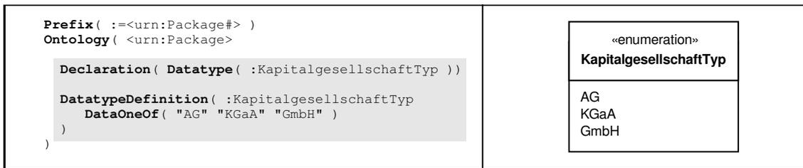
Abbildung 8.12. Beispiel für die Transformation einer Datentypdefinition mit Hilfe des `DataOneOf`-Axioms in eine Instanz des UML-Elementtyps *Enumeration*.
