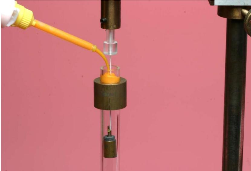
Abbildung 4: Der Probenzylinder wird mit dem Abformmaterial befüllt.
