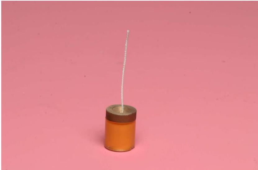
Abbildung 6: Der Prüfkörper, in welchem sich der Retraktionsfaden mittig im abgebundenen Abformmaterial befindet. Eine Kupferplatte ist ihm aufgelegt.
