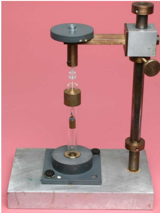
Abbildung 2: Der Retraktionsfaden wird mit Hilfe der Zentriereinrichtung in die Mitte des Probenzylinders gespannt.
