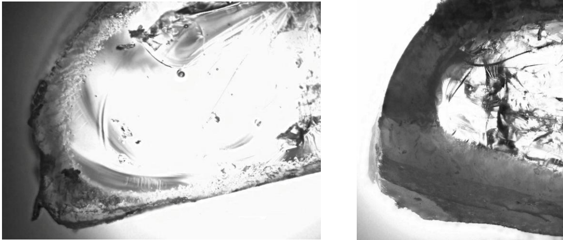
Abbildung 4.6.3.2: Querschnitt durch gelagerte Extrudate mit Rekristallisationsschicht und innerem amorphem Kern (Beispielhaft gezeigt sind Lactitol Monohydrathaltige Extrudate, hergestellt auf einem ZSK 18: links nach vierwöchiger Lagerung und rechts nach achtwöchiger Lagerung, beides im offenen Glasgefäß und bei 25 °C und 60 % rF)
