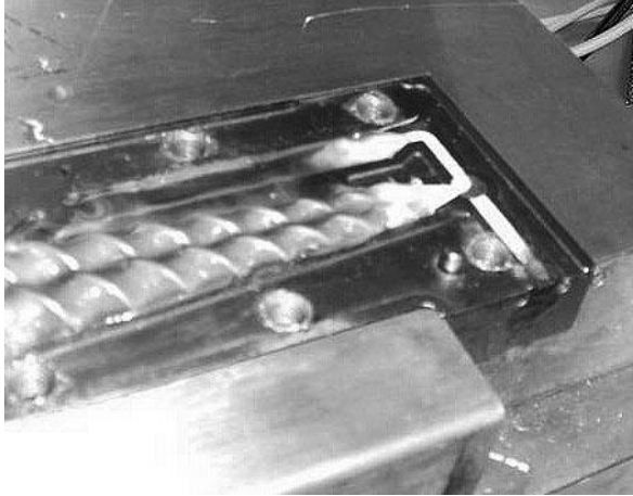
Abbildung 4.3.2.1: galenIQ™ im MiniLab bei 130 °C, auf den Schnecken und Teilen des Rückflusskanals ist die transparente Schmelze zu erkennen, in den Fließkanälen zum Rückfluss und auch in Richtung des Auslasses ist in weißer Farbe das kristalline Isomalt zu sehen.
