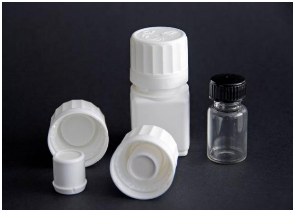
Abbildung 3.2.2.1: Links ist ein Deckel mit herausgenommener Trockenmittelkapsel zu sehen, vorne der Deckel mit der integrierten Kapsel, hinten rechts sind die Gefäße abgebildet, wie sie auch eingelagert werden (Polyethylenfläschchen mit fest geschlossenem Deckel und Glasfläschchen mit lose aufgelegtem Deckel).
