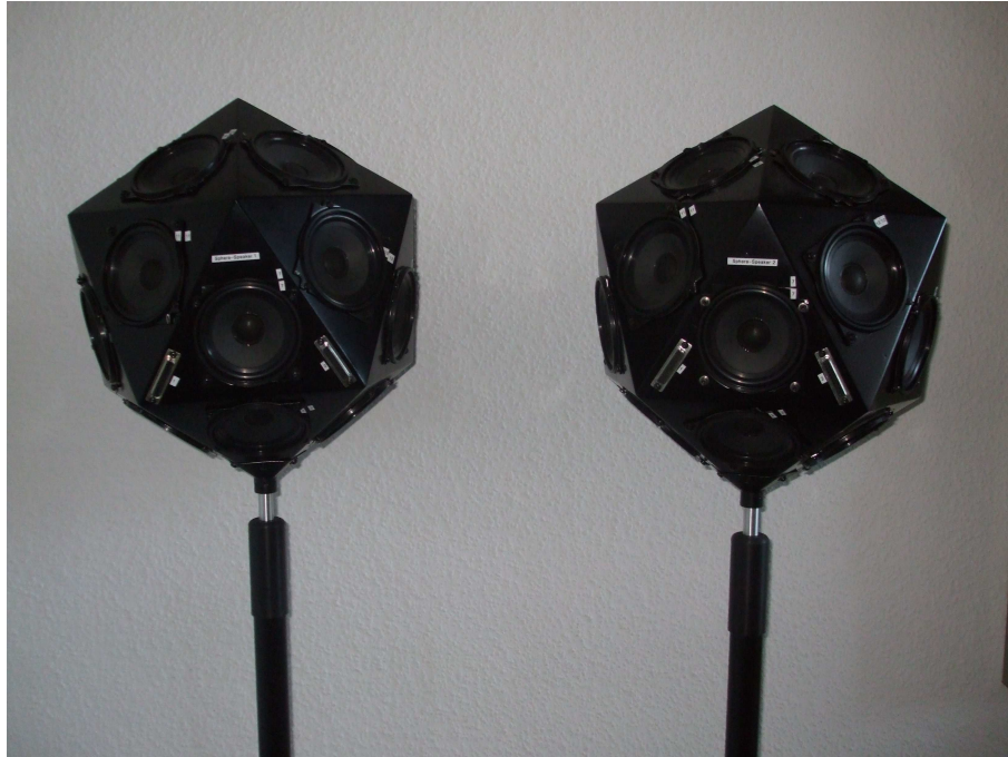
Abbildung 7.4: Darstellung der beiden fertiggestellten Kugellautsprecherarrays, die jeweils auf einen Ikosaeder als Grundkörper basieren und einen Außendurchmesser von jeweils \varnothing_{\text{Ikosaeder}_{\text{Außen}}} \approx 40 [cm] aufweisen.
