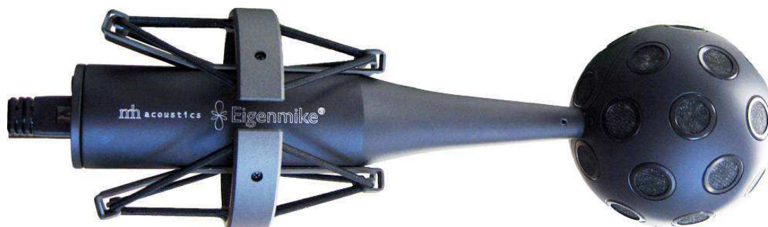
Abbildung 5.8: Geschlossenes, sphärisches Kugelmikrofon der Firma MH Acoustics mit einem Radius von a = 0.042 [m], welches aus Q = 32 omnidirektionalen Mikrofonen besteht, die quasi-regulär angeordnet sind. [CCFS10]
