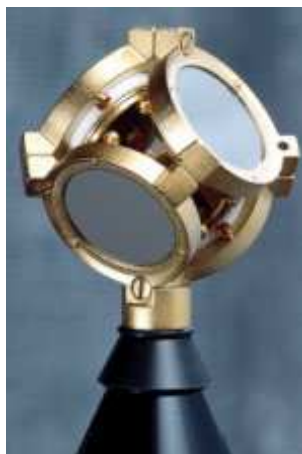
Abbildung 4.1: Klangfeldmikrophon der Firma „SoundField“. [Sou12]
