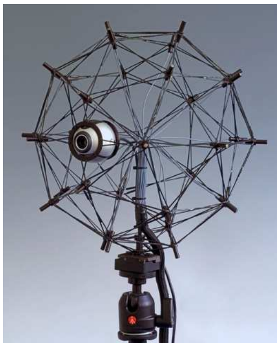
Abbildung 5.5: Offenes, sphärisches Kugelmikrophon der Firma „Acoustic Camera“ mit einem Radius von a = 0.175 [m], welches aus Q = 32 differentiellen Mikrofonen 1. Ordnung besteht. [IIE]
