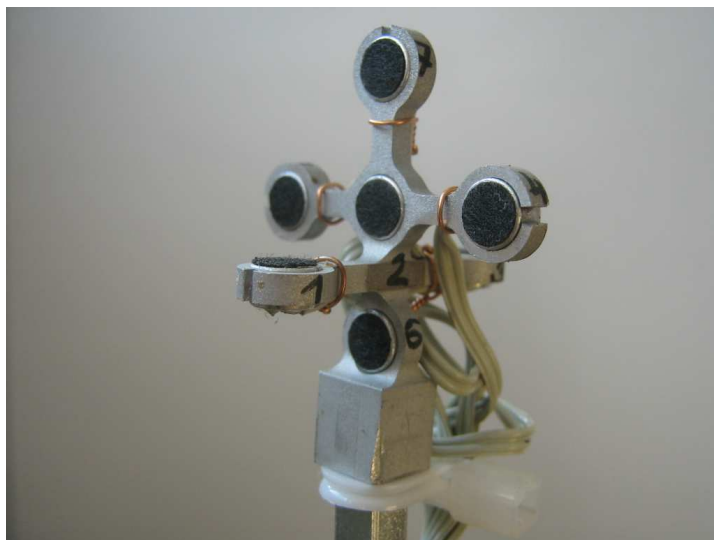
(a) Ideales Chassis auf dem das offene Kugelmikrophonarray, d.h. der offene modale beamformer beruhen sollte. (b) Real verwendetes, mit omnidirektionalen Mikrophenen bestücktes, offenes Kugelmikrophonarray.
