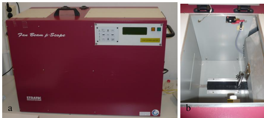
Abbildung 5: Mikrocomputertomograph Der FAN Beam \mu -Scope (STRATEC Medizintechnik, Pforzheim) dient zur Mikrocomputertomographie der Femora der Mäuse (a). Im Innenbereich (b) sieht man die Röhre(*), in der das Femur positioniert wird.
