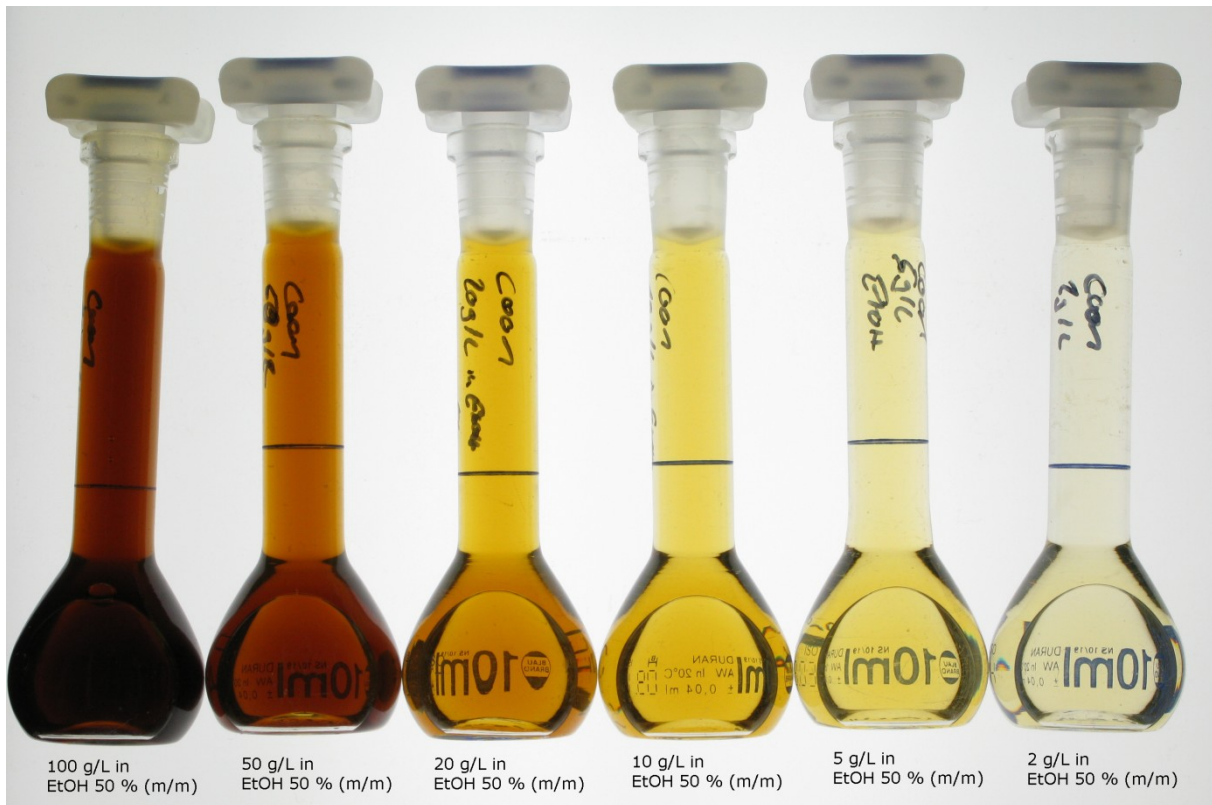
Abb. 41 Löslichkeit von C001 in Ethanol 50 % (m/m)
