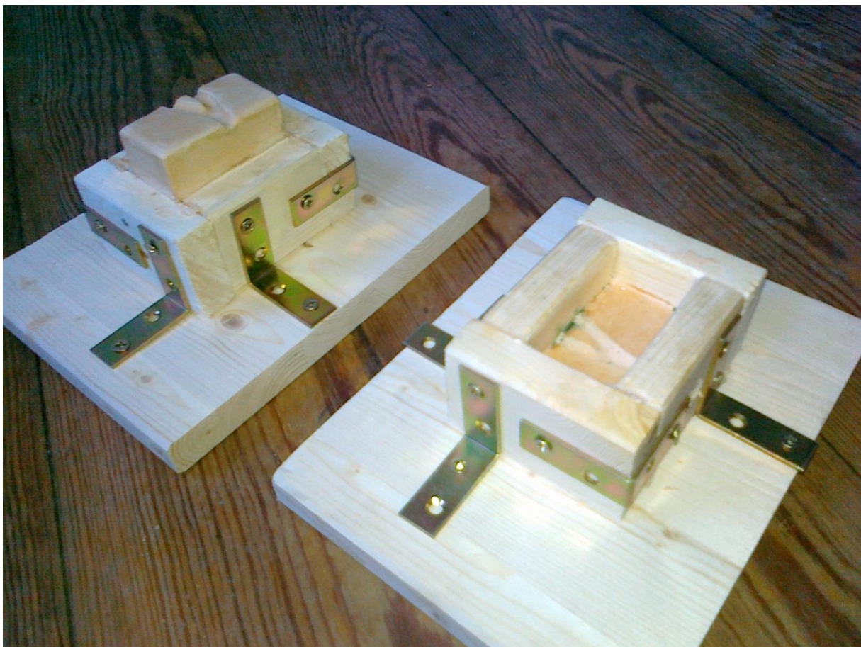
Abb. 7 Negativform aus Gips mit Holzverschalung
