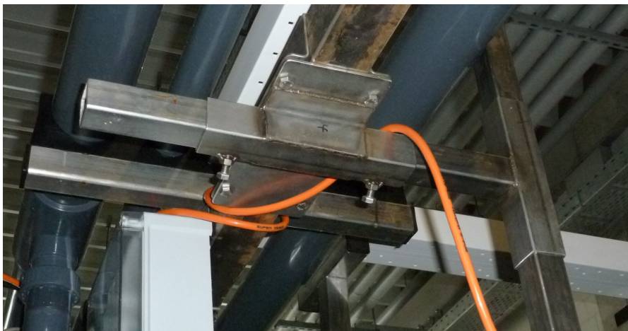
Abbildung 3.13: Halterung für Kameragehäuse und Beleuchtungssystem montiert an Trägerstange über Fischbecken.
