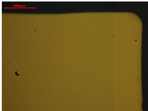
(a) OLED-Oberfläche vor dem Spin-Coating von PCBM:P3HT; Schichtdicke der Kathode 140 nm.
