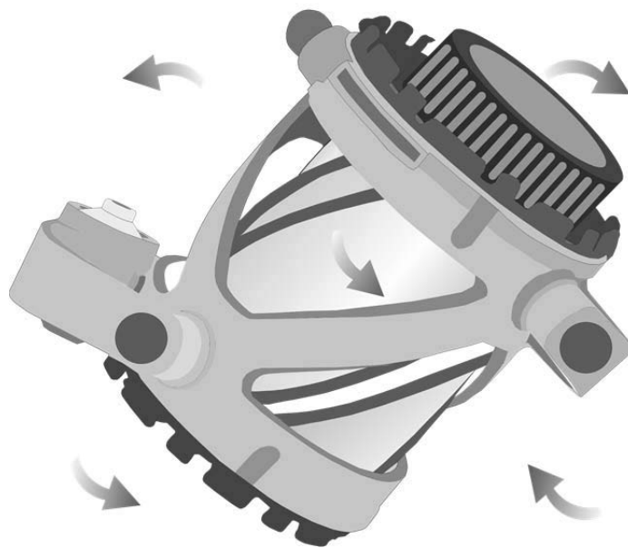
Abbildung 3-6: Funktionsweise des Turbula-Mischer
