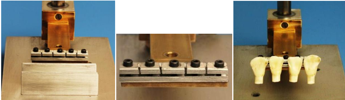
Abbildung 4: Darstellung der Positionierungshilfe. Von links: Übersichtsaufnahme mit aufgestellter Einbettform, Nahaufnahme der Schiene, einligierte Zähne vor der Einbettung.
