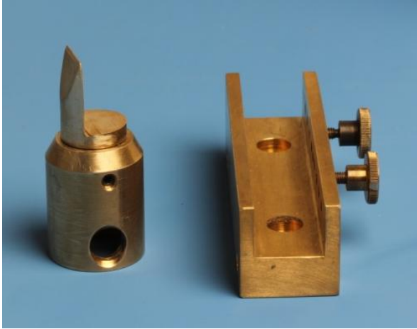
Abbildung 7: Schraubzwinde zur Aufnahme des Einbettblockes und Scherstempel.
