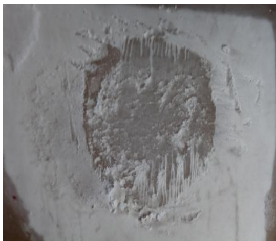
Abbildung 21: Beispiel für Schmelzausriss. Lichtmikroskop 20-fach
