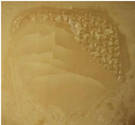
Abbildung 14: Beispiel für ARI-Wert 1. <50 % Restadhäsiv auf der Schmelzoberfläche.
