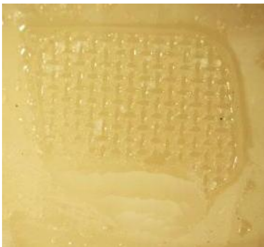
Abbildung 16: Beispiel für ARI-Wert 2. >50 % Restadhäsiv auf der Schmelzoberfläche.
