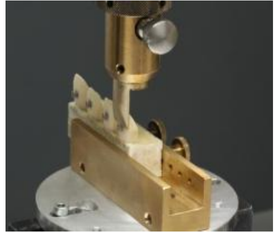
Abbildung 8: Eingespannte Prüfkörper vor der Haftkraftmessung.
