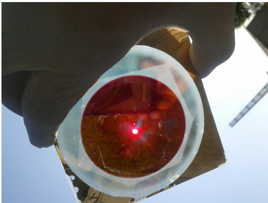
Abbildung 3.13: Photoaufnahme einer 10 \times 10 \text{ cm}^2 Aluminiumfilm auf Glass-Substrat. Der Film wurde anodisiert (Außerkreis) und Au-Nanodrähte wurden elektrochemisch abgeschieden.
