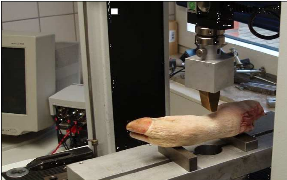
Abbildung 5 Erzeugung von Frakturen durch die Materialprüfmaschine
