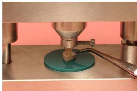
Abb. 11: Überschussentfernung von Multilink Automix
