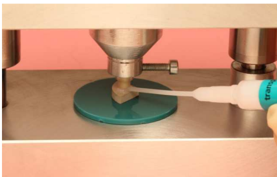
Abb. 12: Auftragen von Liquid Strip
