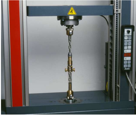
Abb. 15: Universalprüfmaschine (Zwick Z010) mit eingespannter Probe
