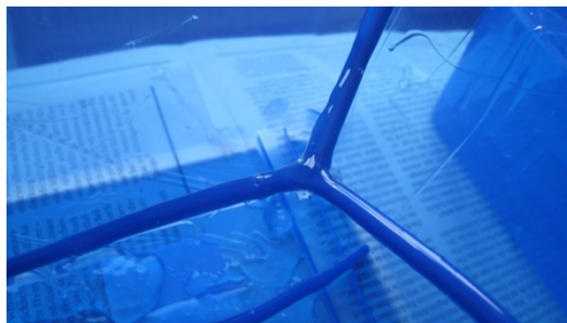
Abbildung 3-4: Vulkanisationsvorgang. Silikon auf Wachsdraht (Quelle: eigene Aufnahme, 2011)
