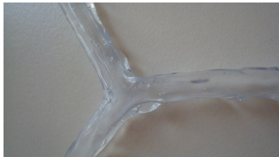
Abbildung 3-5: Silikonbifurkation nach Vulkanisation und Entfernen der Wachsdrahtmasse (Quelle: eigene Aufnahme, 2011)
