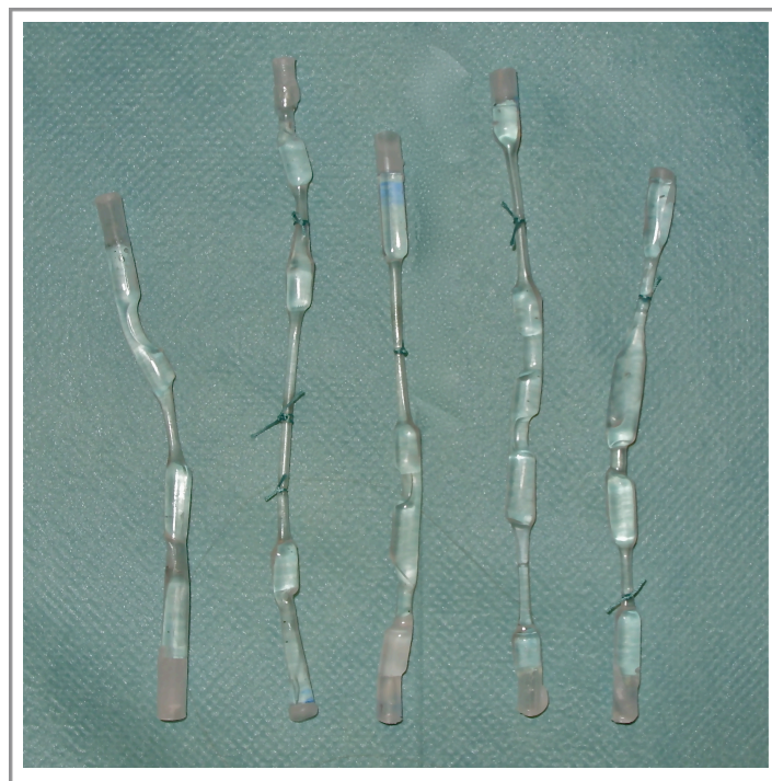
Abbildung 7: Gefäßmodelle mit verschieden geformten Stenosen
