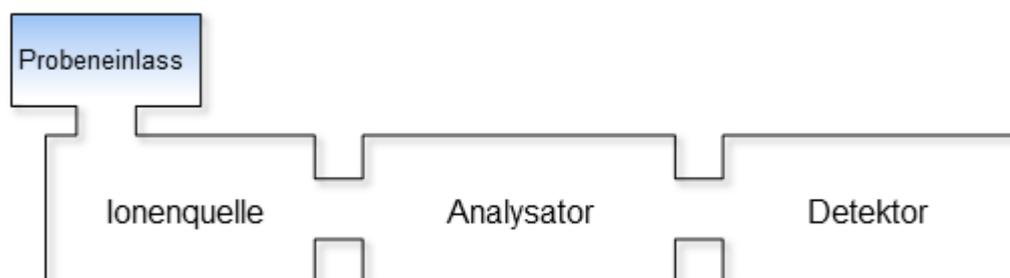
**Abb. 1.10:** Schematischer Aufbau eines Massenspektrometers.
