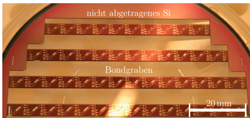
Abb. 3.9.: Träger- und Devicewafer nach der anisotropen Unterätzung der Filamentstrukturen und Freilegung der Bondgräben.
