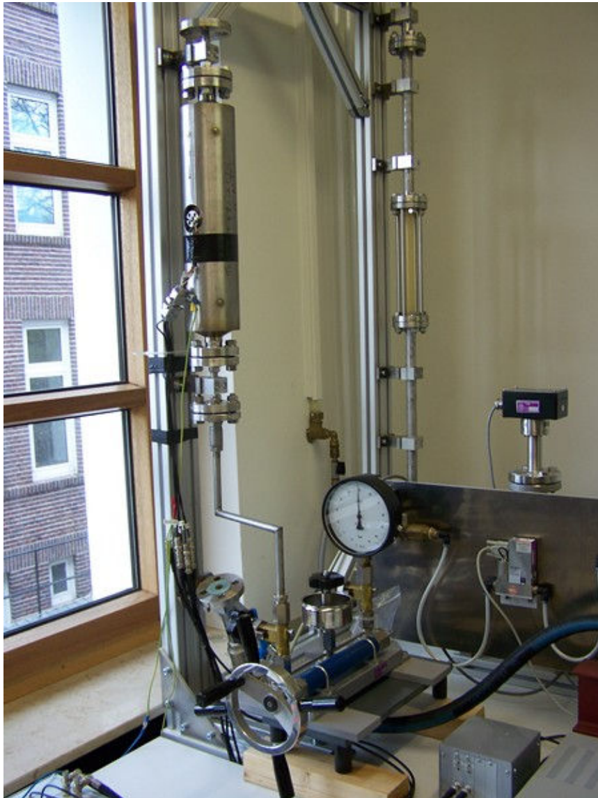
Abbildung D.1: Manometerprüfpumpe für den Druckversuch
