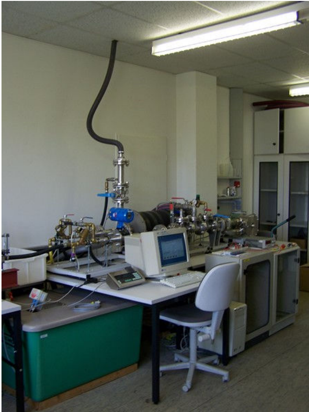
Abbildung C.6: Detailansicht Durchflussmessstrecke – rechte Hälfte: PC mit DFM-Control Software und Schaltschränke für die Ansteuerung sämtlicher Ventile und Pumpen
