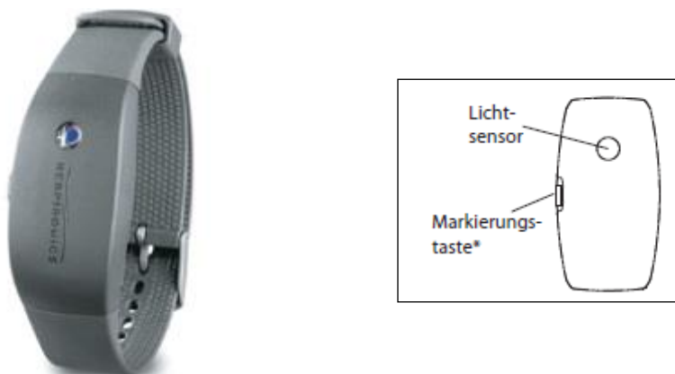
Abb. 13: Die Actiwatch2 (Philips Respironics) (Quelle: URL4) und eine schematische Aufsicht auf das Gerät. Auf der Vorderseite der Actiwatch2 befindet sich ein Lichtsensor, seitlich eine Markierungstaste (Quelle: Actiwatch Spectrum & Actiwatch2 Wearer Guide, Philips Respironics).
