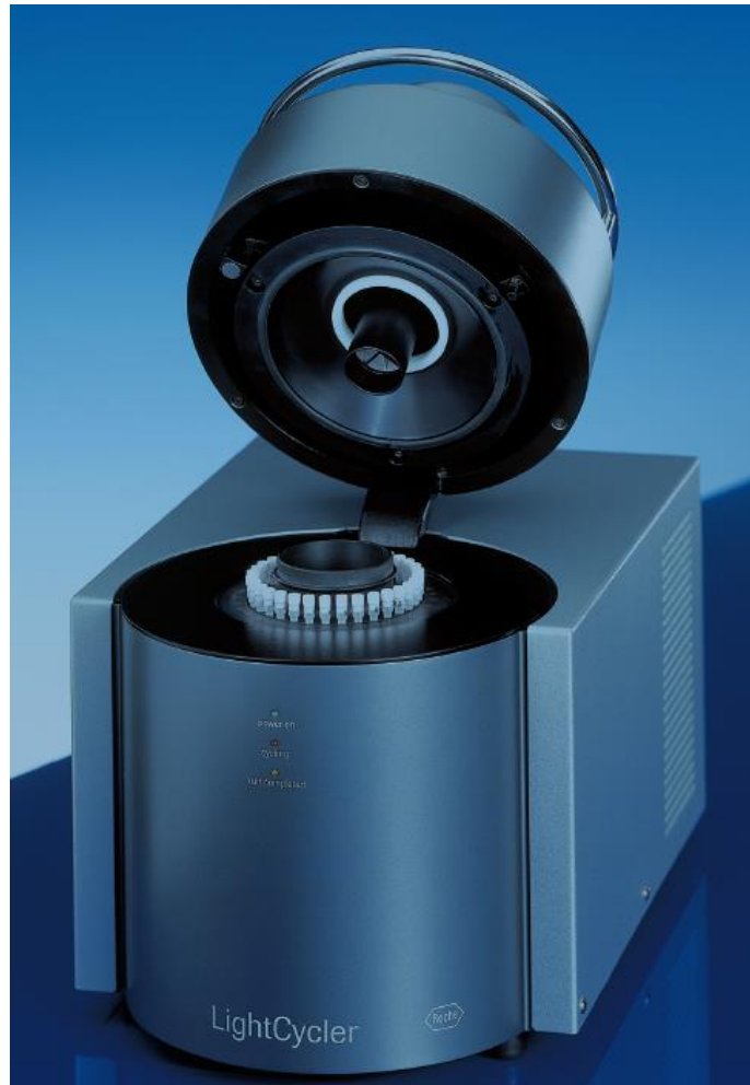
Abb. 26: Außenansicht des LightCycler-Geräts von Roche mit geöffnetem Deckel. Zu erkennen ist das Probenkarussell mit eingesetzten Kapillaren (verändert nach LightCycler Operator's Manual Version 3.5).
