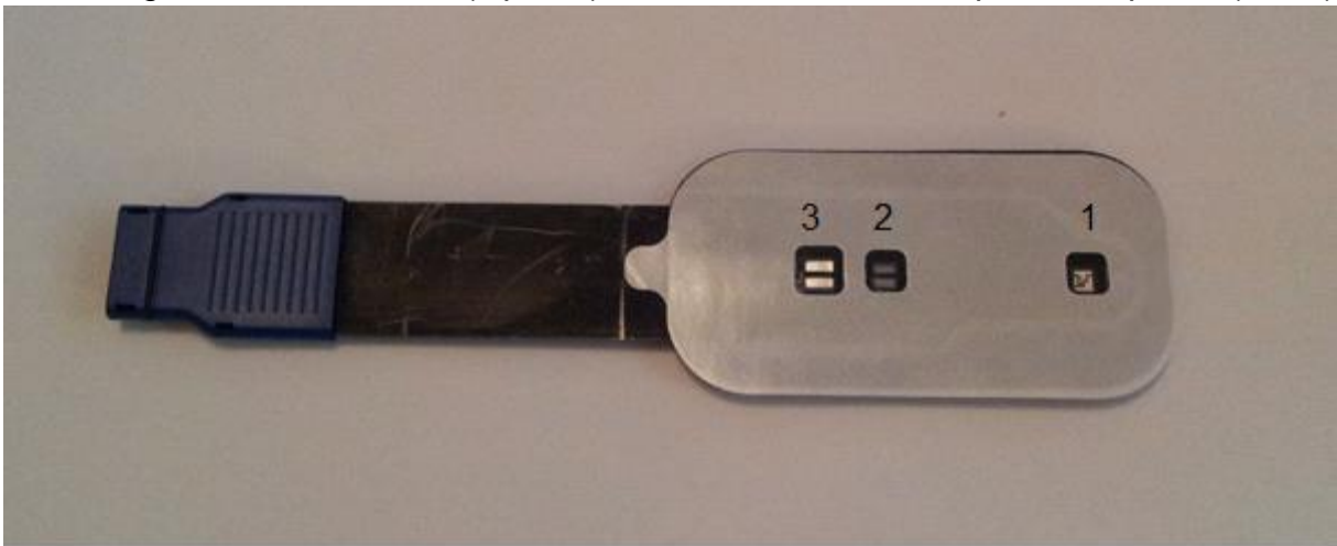
Abbildung 1: Sensor (Optode) für Nah-Infrarot-Spektroskopie (NIRS)
