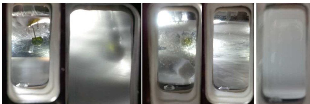
Abbildung 4.66. Zeitlicher Verlauf der Reaktion zur Bildung des benzylverbrückten PMO in der in-situ -Kristallisationszelle (von links nach rechts). Zunächst ist direkt nach der Zugabe des 1,4-Bis(triethoxysilyl)benzol Prekursors noch eine klare Lösung zu erkennen. Etwa 20 Minuten später setzt die Trübung der Lösung ein (zweites Bild). Nach 20 Stunden bei Raumtemperatur haben sich bereits erkennbare farblose Partikel in der Lösung gebildet. Auf dem vierten Bild ist die Aufheizphase auf 95 °C dargestellt. Hierbei ist zu erkennen, dass die vorhandenen Partikel wieder in Lösung gehen bzw. deutlich kleiner sind. Im letzten Bild ist das Reaktionsgemisch nach der kompletten Kondensation (24 Stunden bei 95 °C) gezeigt.
