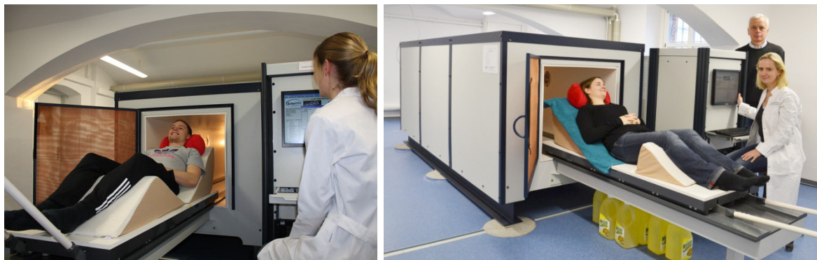
Abbildung 1 QMR-Gerät der Firma EchoMRI™ LLC (Houston, Texas USA) mit typischer Probandenlagerung vor dem Einschleiben zur Messung (links Frontalansicht und rechts Seitenansicht mit Rapsölcontainern unter der Probandenliege zur Kalibrierung)
